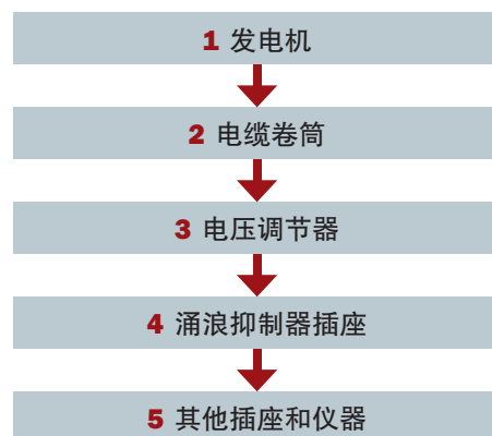
图四：连接顺序。按照上述顺序连接设备，确保设备一定要按此顺序连接。
