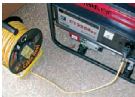
图一：将电缆卷筒插到发电机上。注意：将插头插上之前，先将卷筒上的电缆线展开。
