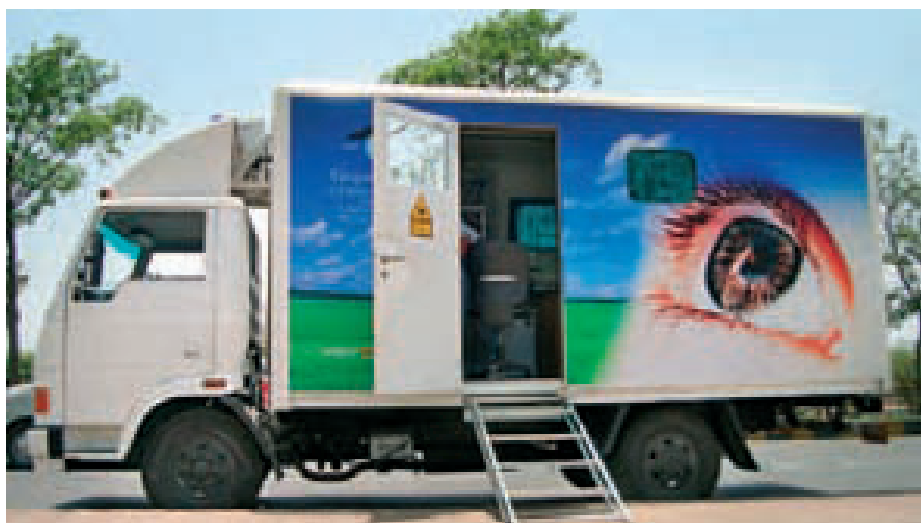
专门设计的流动检查治疗车，配备了空调和齐全的设备：裂隙灯、视野仪、数码眼底照相机、激光及发电机。印度
